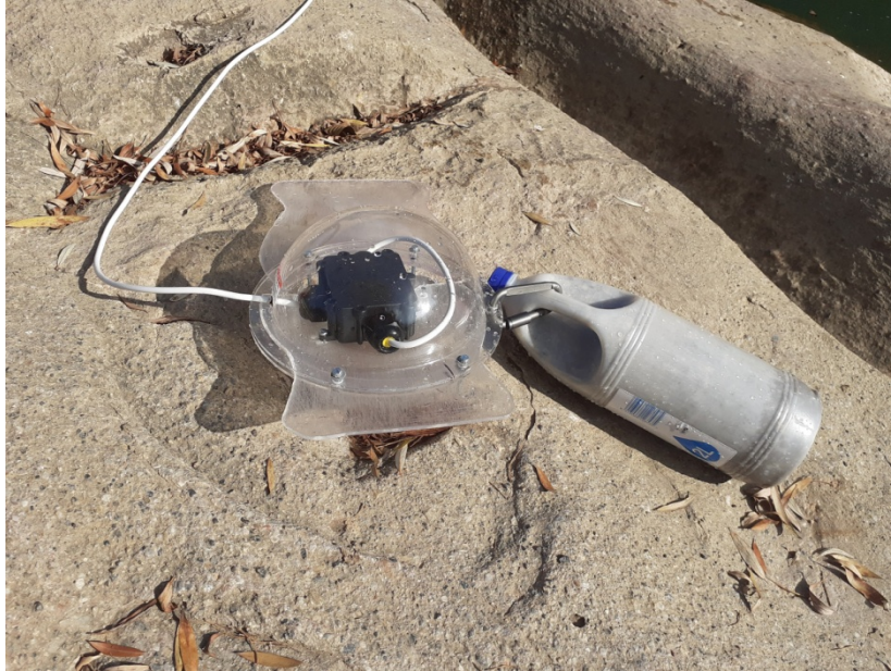
Figura 6.5-1. Proves de càrrega amb diferents quantitats de sorra en ampolla de plàstic.
