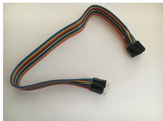
Figura 12: Cables de connexió. Setembre de 2018. (Elaboració pròpia)
