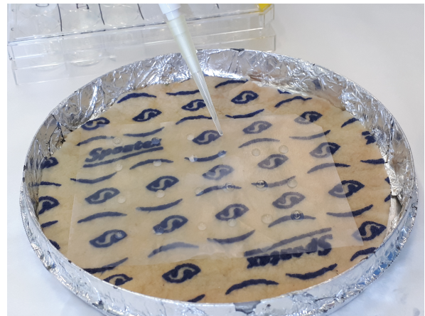
Parafilm amb gotes de la dissolució del Buffer 4. Imatge feta per l'autora.
