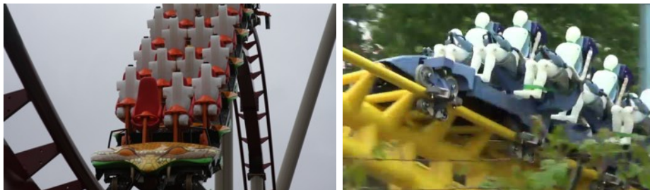
Utilització de maniquins per a la verificació del funcionament de les muntanyes russes
