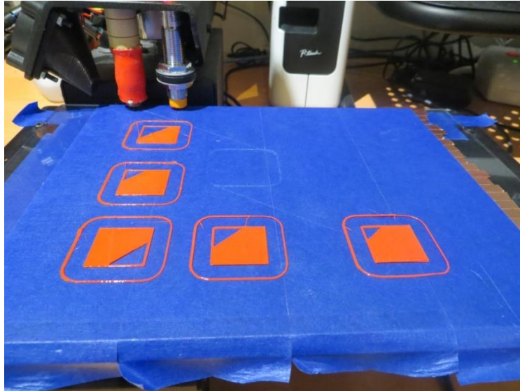
Llit d'impressió cobert amb cinta de pintor blava d'una impressora Printrbot. Extret de: http://fpynter.com/2015/11/glass-print-bed-for-printrbot-simple-metal-part-iv/
