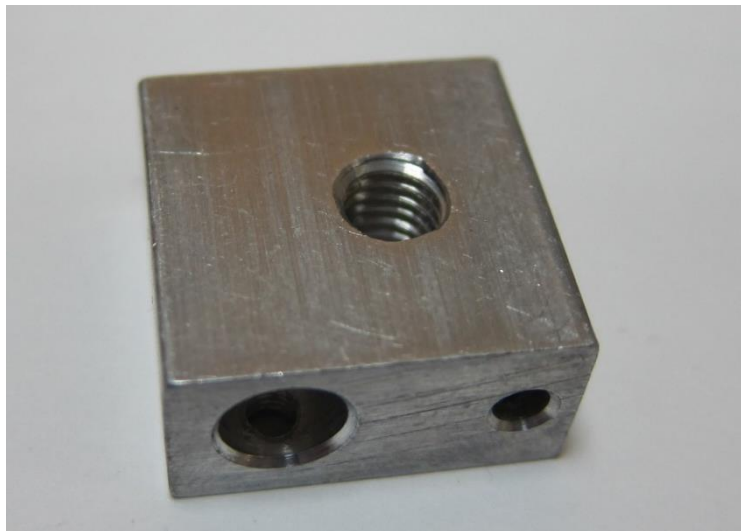
Heating Block d'alumini. Els forats són pel Nozzle, un termistor i un Heater Cartridge, que veurem més endavant. Extret de: http://makershopbcn.com/en/product/heating-block-for-aluminum-hotend
