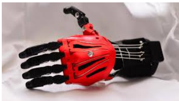
Imatge 8. Pròtesi articulada d'una mà i el canell fabricada per mitjà de la impressió 3d
