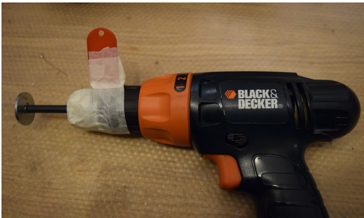
Fig. 38. Disposició del trepant per enrotllar el fil
