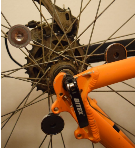
Fig. 25. Imants aferrats als radis
