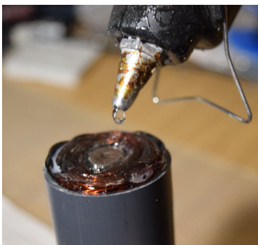
Fig. 57. Aplicació de la cola a una bobina
