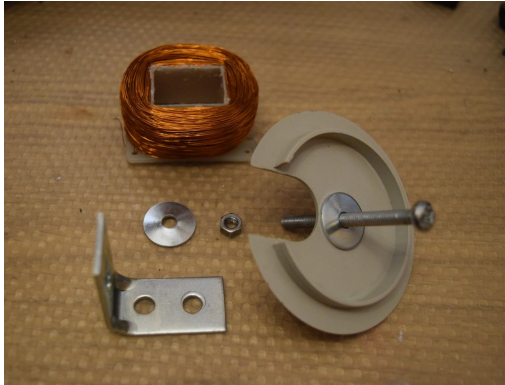
Figs. 33. Invent per subjectar el fil de la bobina
