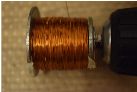
Fig. 46. Bobina de fil de 0,3 mm (prova 6)
