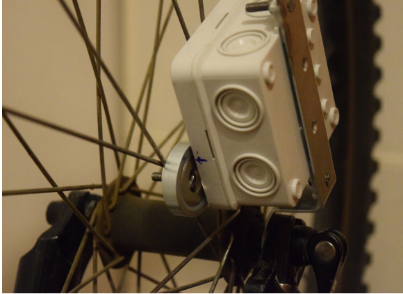
Fig. 44. Caixa encaixada a l'eix de la roda.
