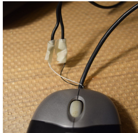
Fig. 37. Cables del ratolí i interruptor units
