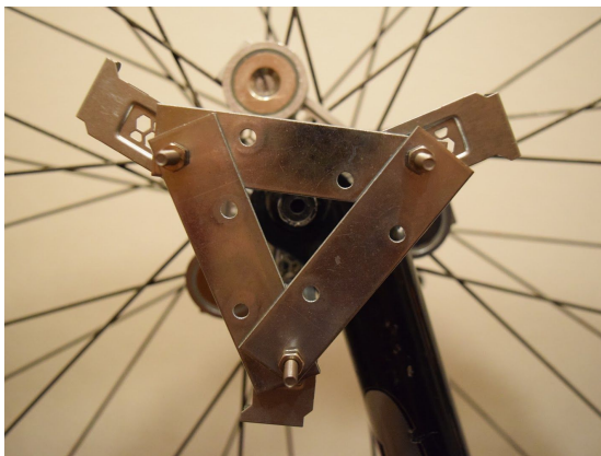
Fig. 53. Reforç de platines
