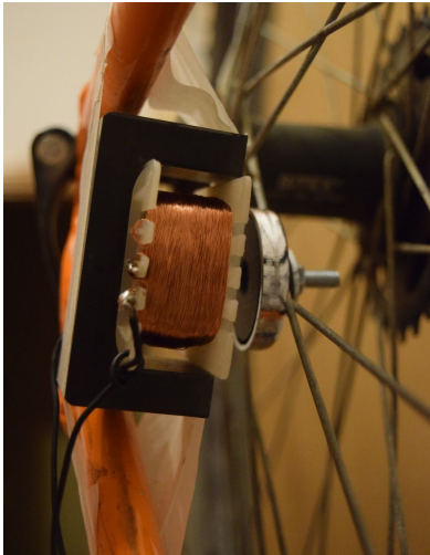
Fig. 31. Bobina prova 2 aferrada a la bicicleta
