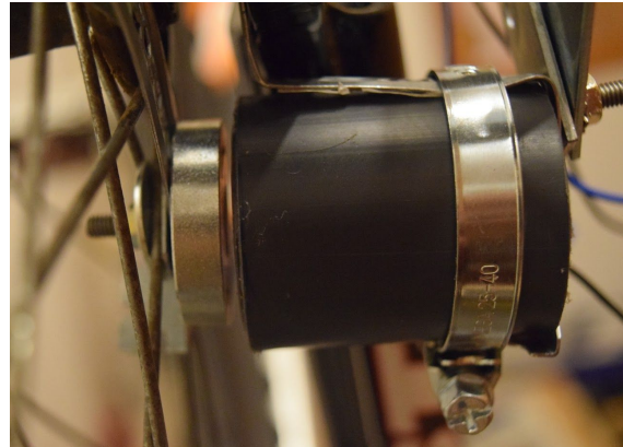
Fig. 61. Abraçadores per subjectar les bobines
