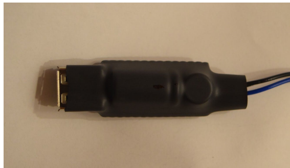
Fig. 69. Circuit envoltat amb macarró termoretràctil
