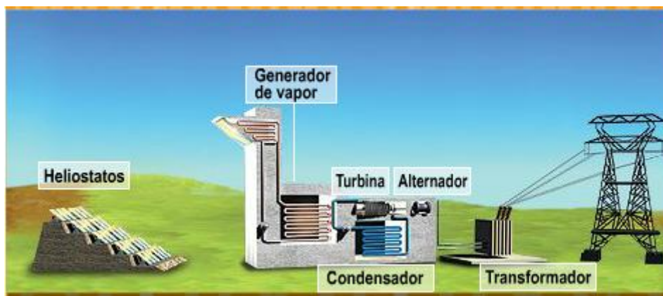
Figura 2. Esquema d'una central solar tèrmica
