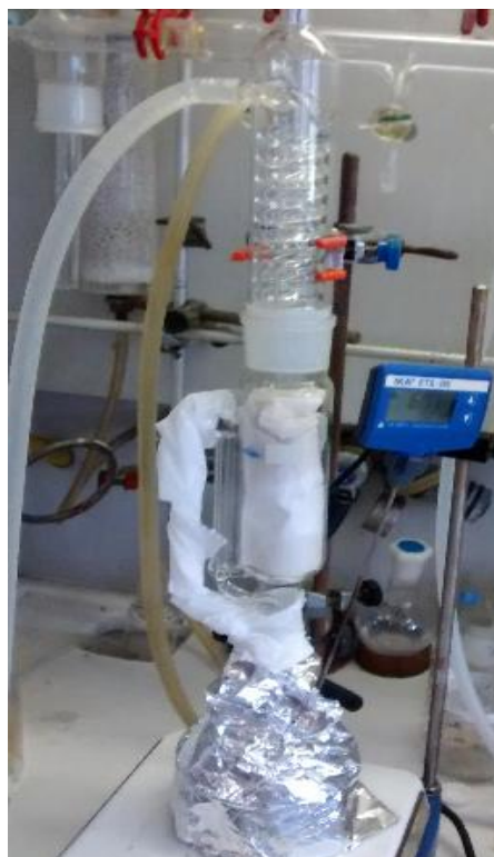
Figura 10. El muntatge del extractor
