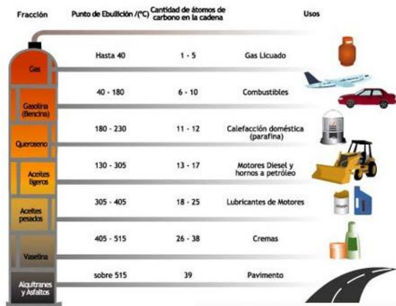
Figura 8. Representació d'una columna de destil·lació del petroli 10
