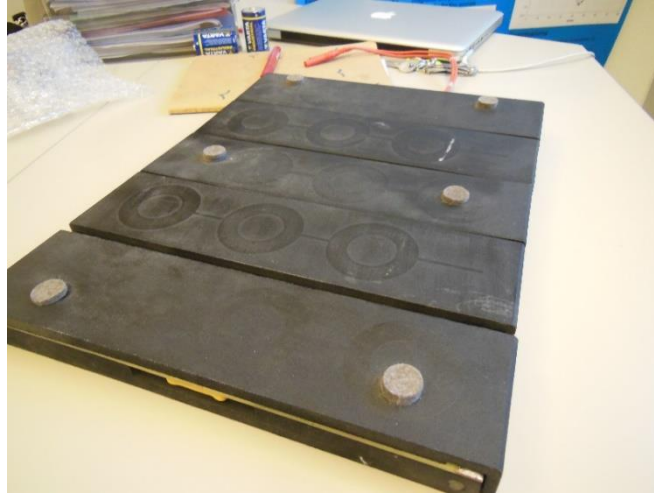
BASE DE LA GÀBIA AMB BOBINES INCORPORADES
