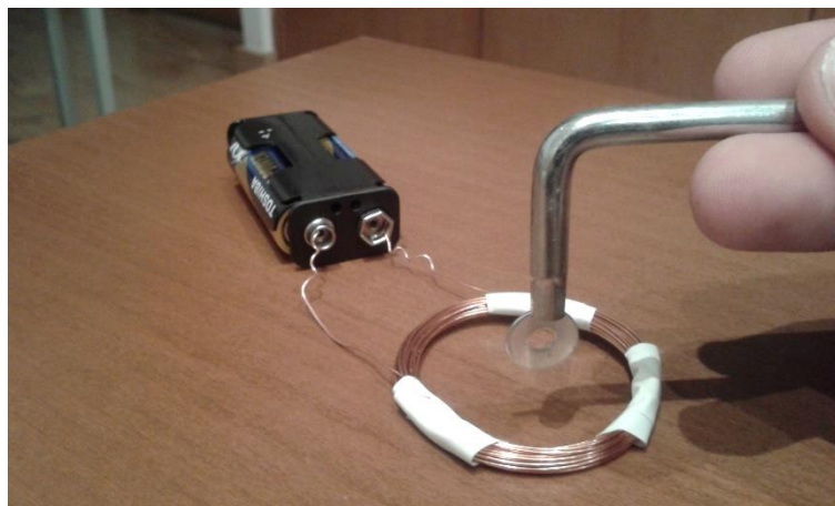
IMANTACIÓ AL APLICAR CORRENT A UNA BOBINA
