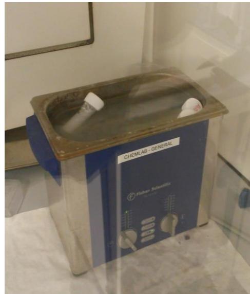
Figura 17. Preparació de les nanopartícules en suspensions col·loïdals i procés de sonicació.
