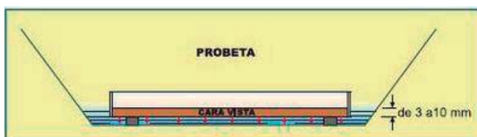
Fig. 1.2.6.1 ESQUEMA ASSAIG DE L'ABSORCIÓ D'AIGUA
