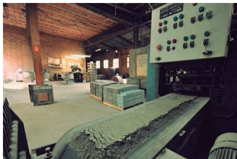
Fig.2.2.2 PROCÉS DE FABRICACIÓ DELS PANOTS. Fotos: FÀBRICA DE MOSAICS CAPDEVILA, S.A.
