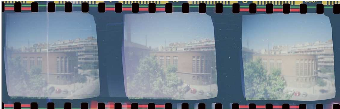
Figura 32: imatges obtingudes amb la càmera estenoipeica Temps d'exposició: 1 s
