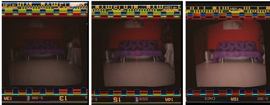
Figura 37 – 38 – 39: imatges obtingudes amb la càmera estenoipeica Temps d'exposició: 15 s Temps d'exposició: 30 s Temps d'exposició: 1 min
