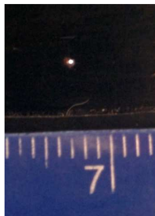
Figura 22: estenop utilitzat en l'experiment Estenop: 0'34 mm Àrea: 0,091 mm 2
