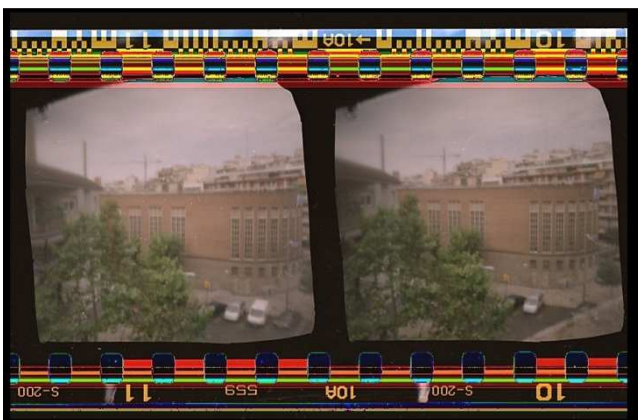
Figura 35: imatges obtingudes amb la càmera estenopeica Temps d'exposició: 3 s
