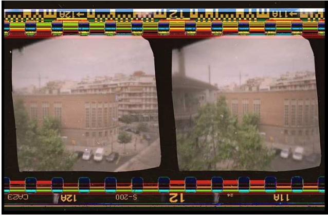
Figura 36: imatges obtingudes amb la càmera estenoipeica Temps d'exposició: 5 s
