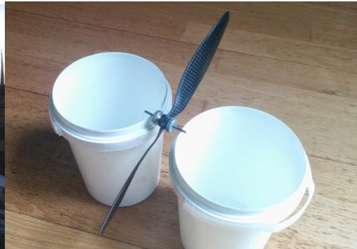
Fig 5.5 Compensació de les pales
