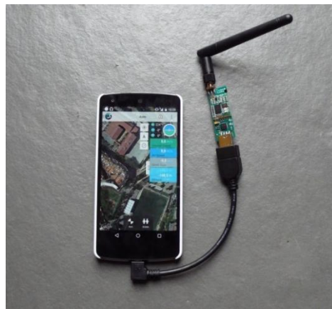
Fig 4.7 Connexió de la telemetria al mòbil.
