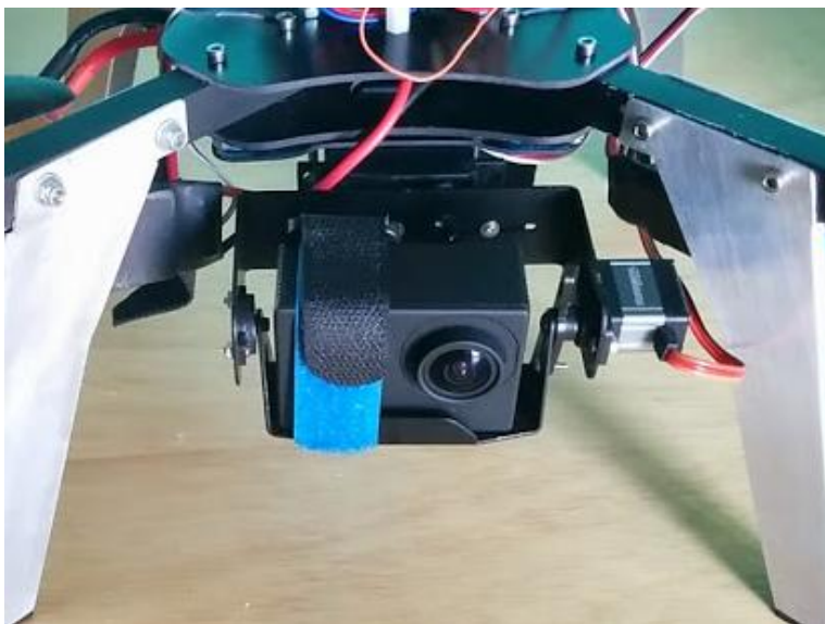
Fig 3.7 Estabilització d'imatge per servomotors.
