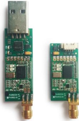
Fig 3.6 Antenes de telemetria
