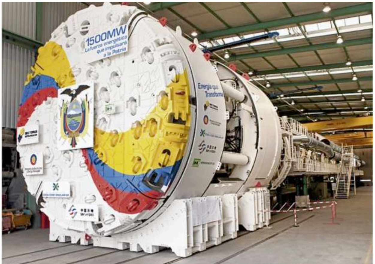
Tuneladora de tipus talp
