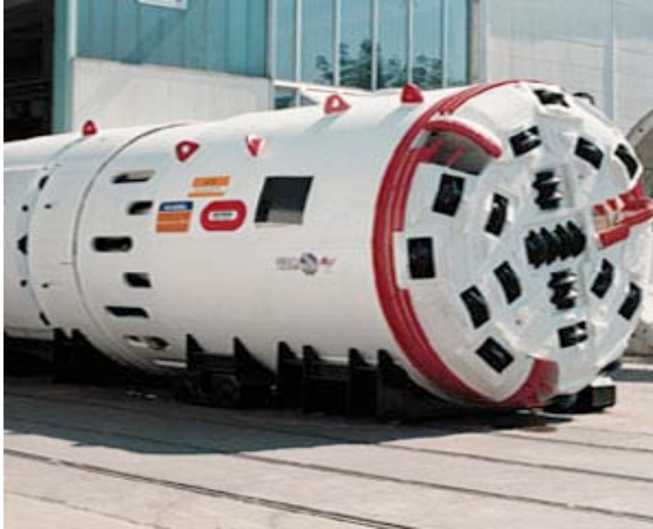
Tuneladora de doble escut
