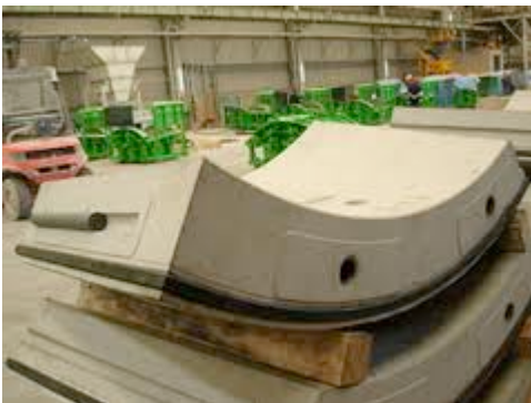
Dovelles de formigó armat
