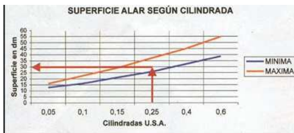
Fig.88.Taula que relaciona la superfície alar amb la cilindrada del motor recomanada.
