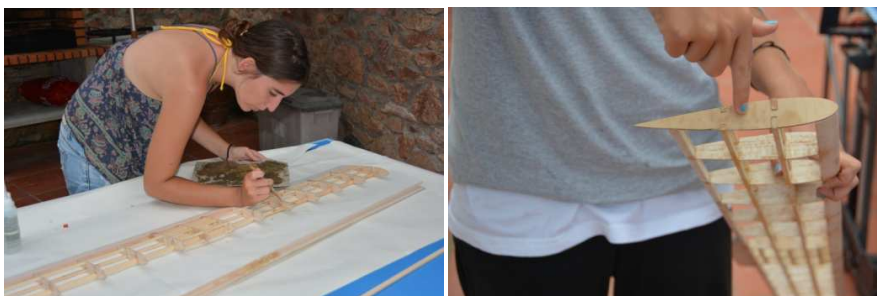
Fig.144.Construcció de l'estructura de l'ala simètrica.
