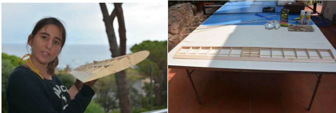
Fig.146.A la dreta es mostra l'estructura de l'ala finalitzada i a l'esquerra,jo aguantant l'ala horitzontalment mostrant el perfil NACA 0014.
