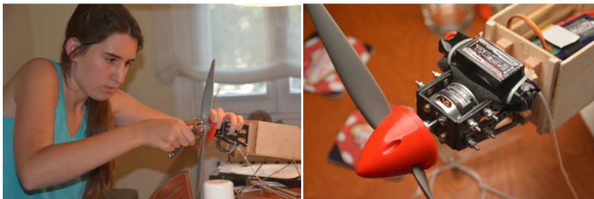
Fig.149.Muntatge del conjunt hèlix, motor i variador.
