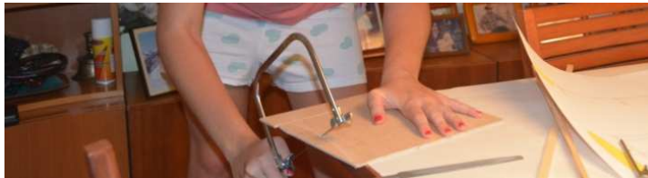
Fig.109.3 costelles de fusta de contraplacat
