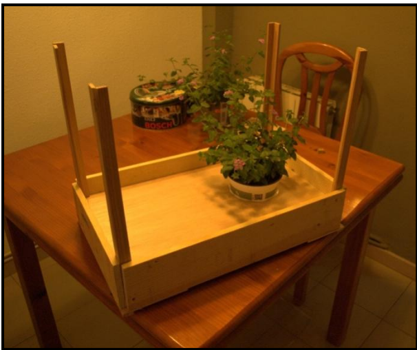
Fig. 5. Muntem les quatre parets, una de les quals serà ventilada.
