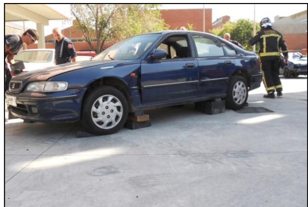
Figures 104 i 105. Estabilització d'un vehicle en posició de marxa mitjançant cunyes, grades i taulons de fusta.
