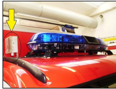
Fig 17. Detall del sensor al costat del pont de llums de l'ambulància S-21
