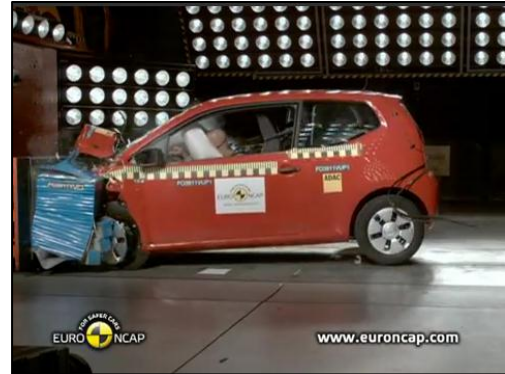
Fig 3.Moment de màxima deformació d'un vehicle del 2011 a 64 km/h
