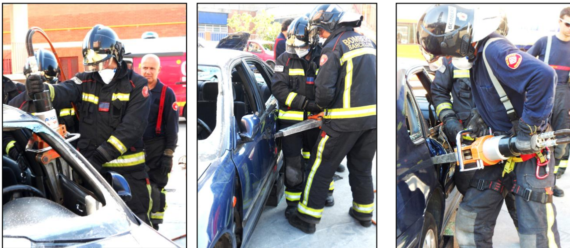
Figures 98, 99 i 100. Maniobra bàsica per a la obertura de la porta del conductor, dins la zona calenta.
