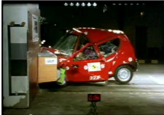
Fig 2 .Moment de màxima deformació d'un vehicle del 1991 a 64 km/h
