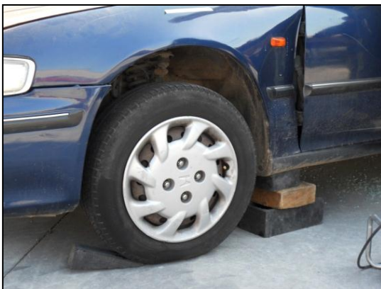
Figures 104 i 105. Estabilització d'un vehicle en posició de marxa mitjançant cunyes, grades i taulons de fusta.
