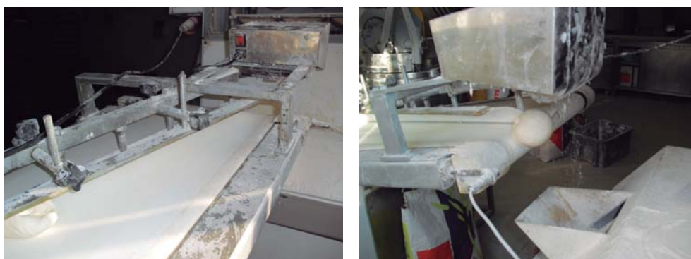
A l'esquerra, la peça a l'inici del carril del funyit i a la dreta, quan s'acaba i ja és esfèrica.
