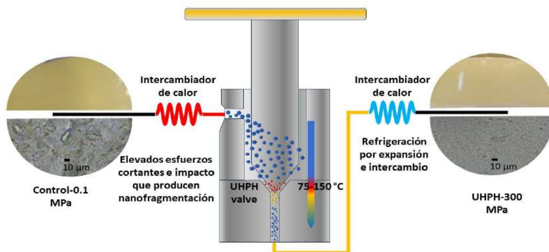
Figura 11. Esquema d'un procés UHPH ( enoReports.com , 2024)
