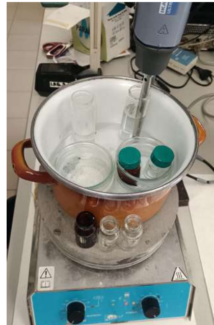
Figura 16. Escalfament de l'equipament i les fases al bany maria
